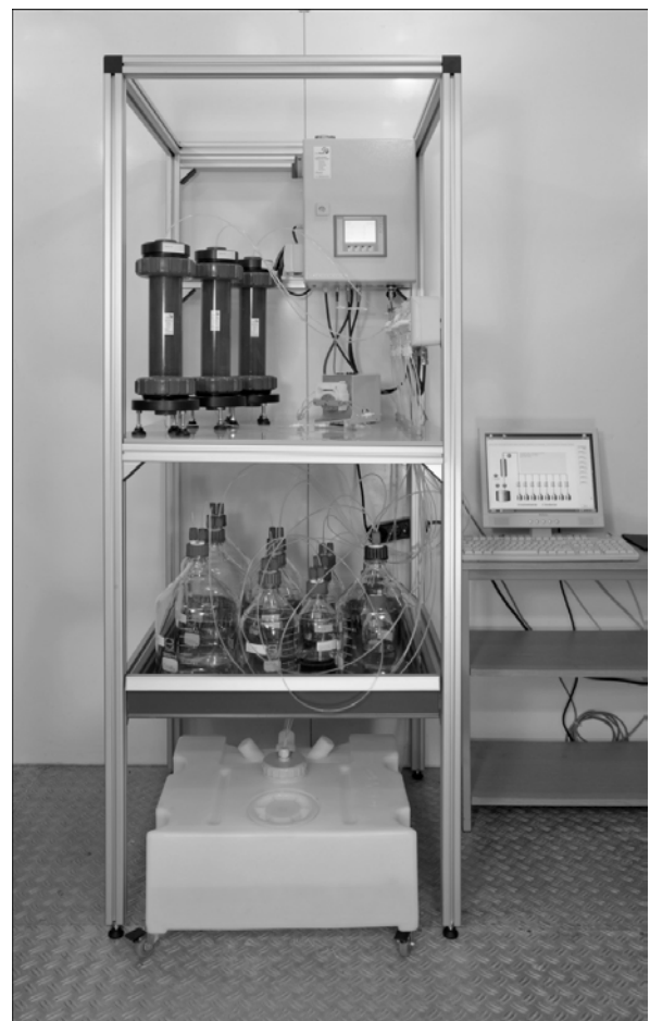
Abb. 4: Automatische Säulenperkolationsanlage (ASPA) entwickelt in Zusammenarbeit durch ecoTech und die BAM
